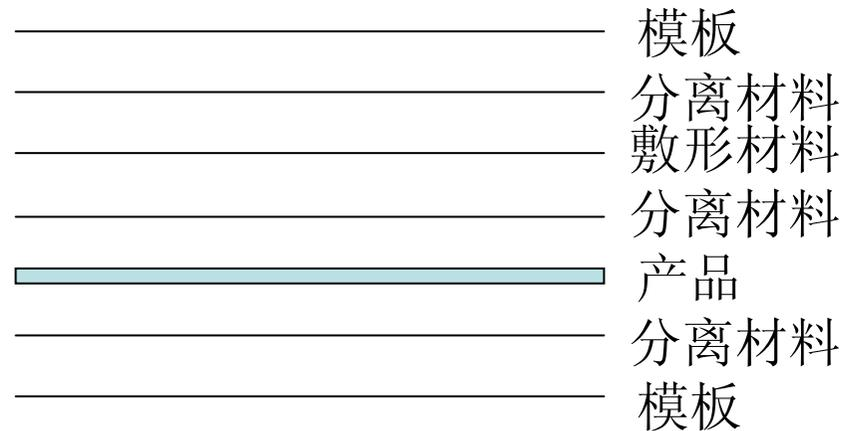
图中所使用的模板，要求使用热变性小，表面平整，厚薄均匀的铝合金板或合金钢板。顶层和底层的模板的厚度一般为8-12mm，中间层的一般为1.5-2.5mm即可。
