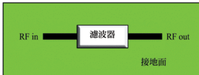
《图二 滤波器四周被接地面（绿色区域）包围》
